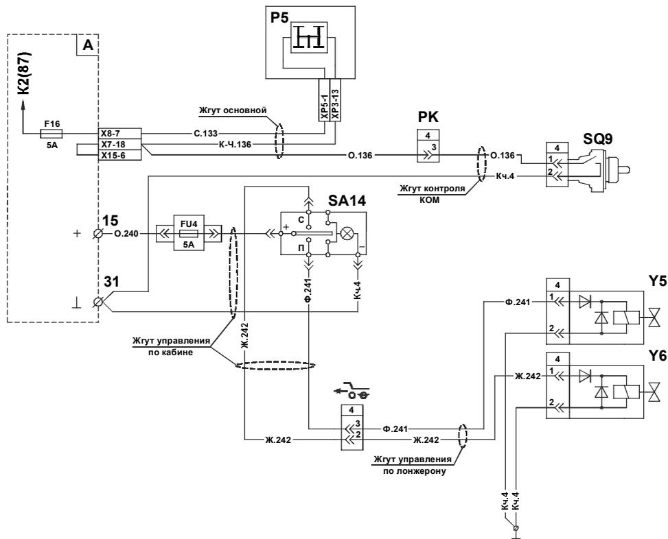
УПРАВЛЕНИЕ САМОСВАЛЬНОЙ ПЛАТФОРМОЙ V=20 м<sup>3</sup>
