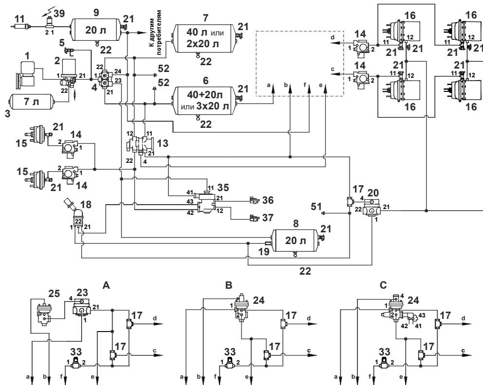
СХЕМА ПРИНЦИПИАЛЬНАЯ ТОРМОЗНОГО ПРИВОДА 6312xx, 6430xx, 6501xx
