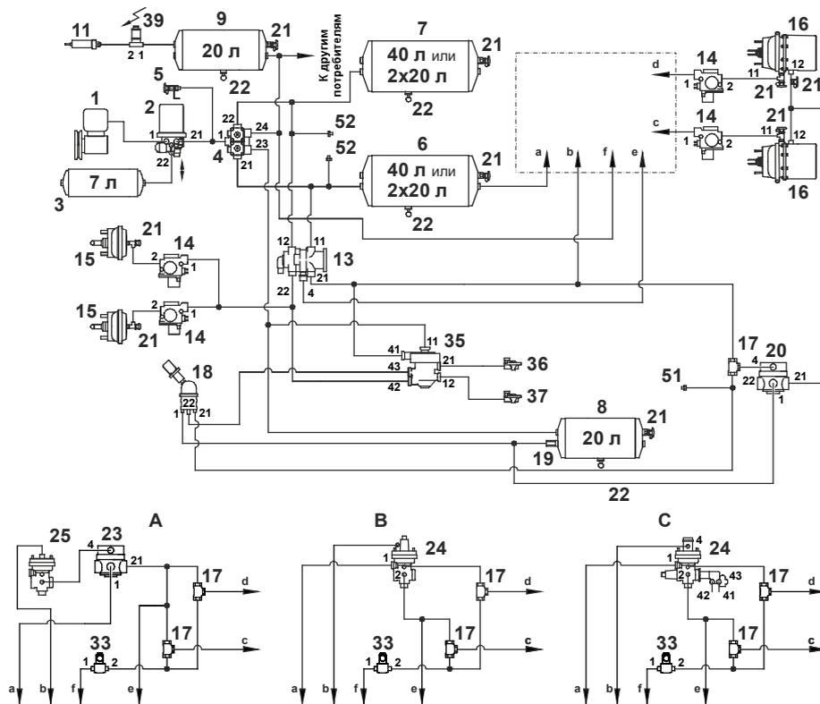
СХЕМА ПРИНЦИПАЛЬНАЯ ТОРМОЗНОГО ПРИВОДА 5440хх, 5340хх, 5550хх
